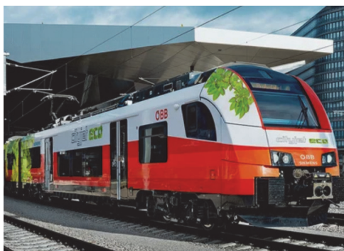
Рис. 3. Desiro ML («CityJet») компании ÖBB в качестве прототипа с аккумуляторами для эксплуатации на линиях с контактной сетью
