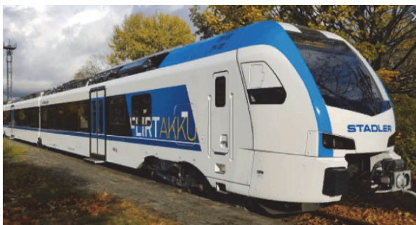
Рис. 4. Моторвагонный поезд FLIRT на аккумуляторной тяге производства компании Stadler Rail для Ассоциации операторов пригородных сообщений земли Шлезвиг-Гольштейн
