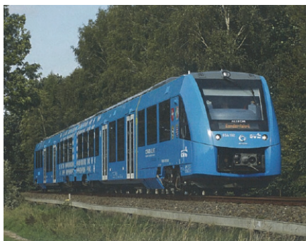
Рис. 1. Моторвагонный поезд Coradia iLint на топливных элементах
