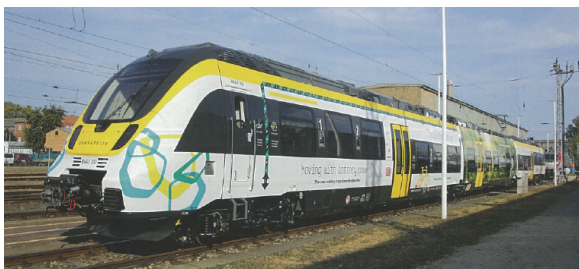
Рис. 2. Моторвагонный поезд Talent 3 с тяговыми аккумуляторами на литий-ионной основе
